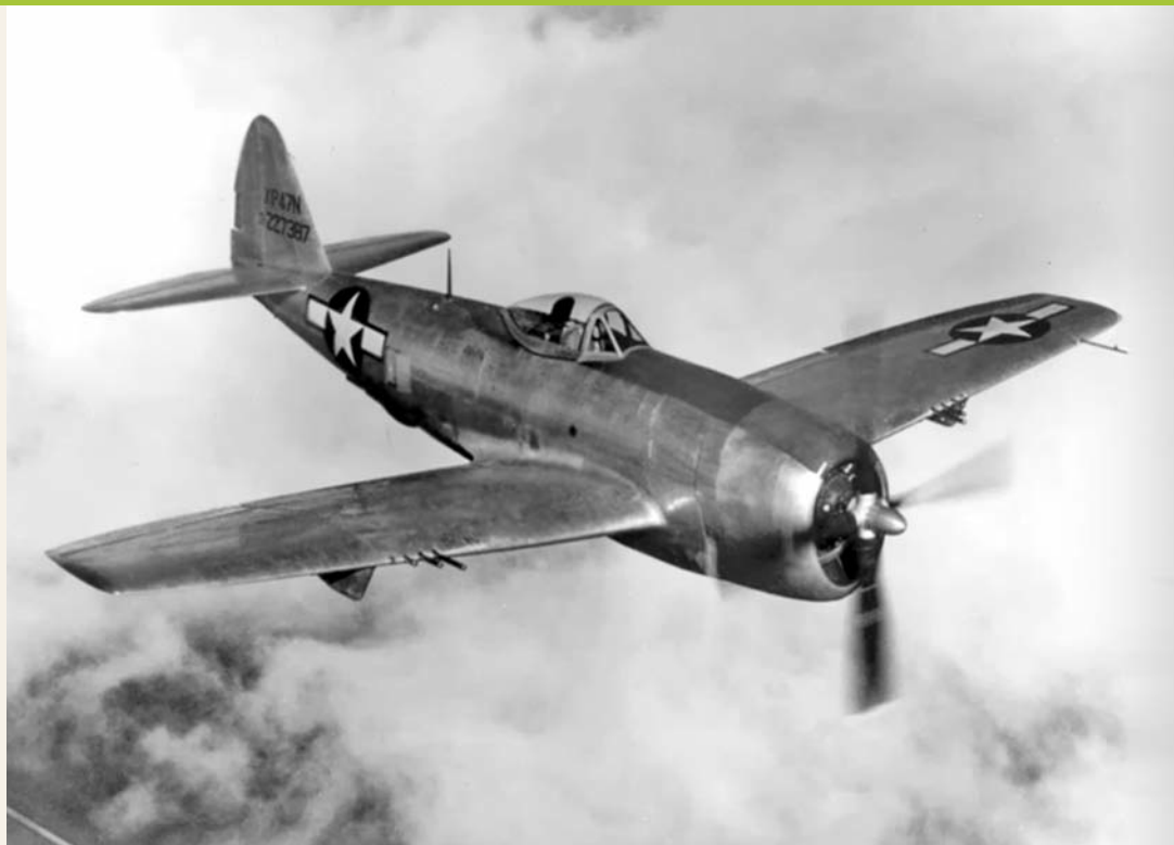
Последња производна варијанта „тандерболта“ био је П-47Н са повећаним крилом са више места за гориво и потребног за дуге летове изнад Тихог океана (РВ САД)
